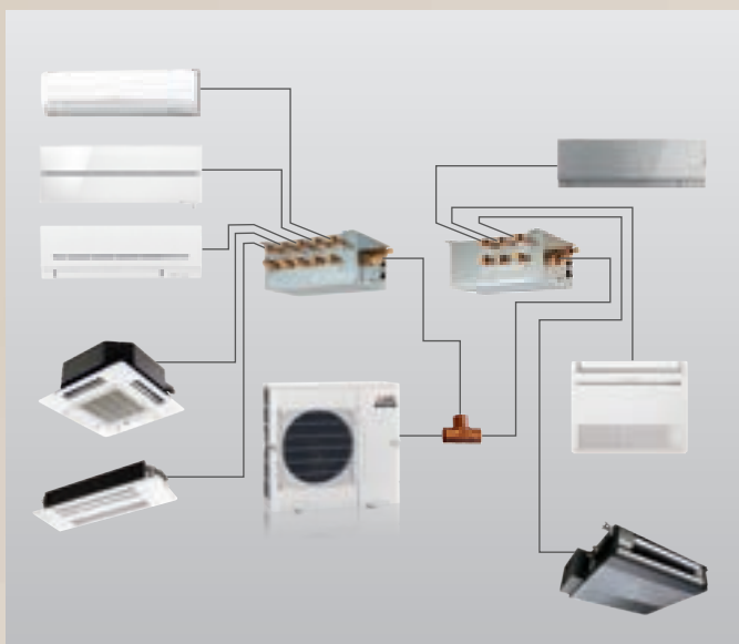
Systeemvoorbeeld met maximaal acht binnenunits
